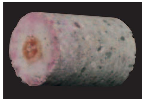
**Testigo de hormigón mostrando hormigón no carbonatado en la izquierda.**
