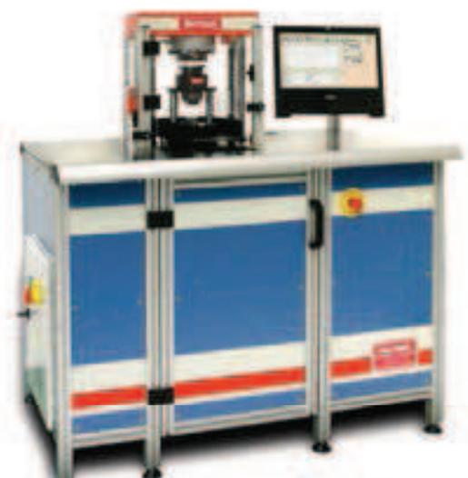
Máquina versión CIB sólo para ensayos a compresión
