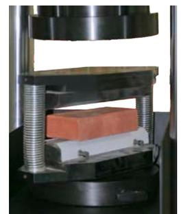
Tracción indirecta de adoquines EN 1338
