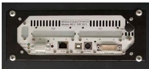
*Módulo MD2, integrado en el bastidor de las máquinas electromecánicas de la serie TESTCOM*
