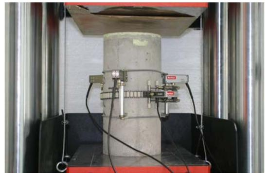
Elasticidad en compresión: determinación del Módulo de Young y Coeficiente de Poisson
