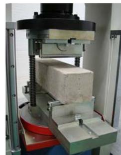
Resistencia a la flexión de hormigón, según EN 12390-6
