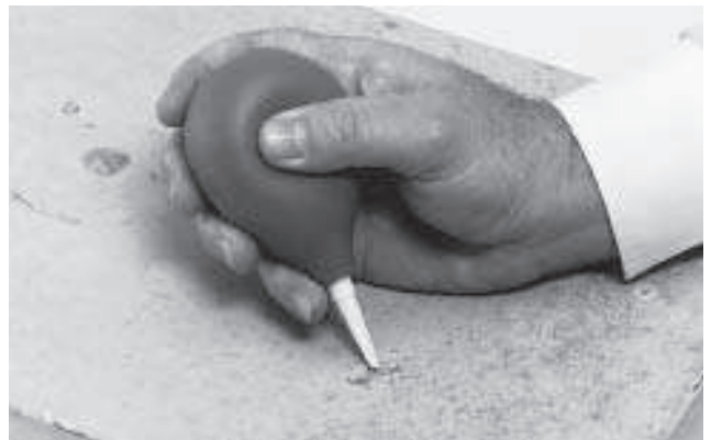
Limpieza Soplador de aire limpiando un agujero de clavo antes de medirlo
