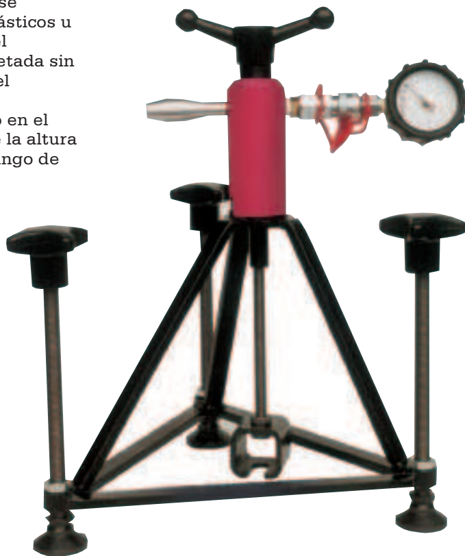
Sistema Estándar de Prueba de Anclajes con Pirámide Difusora de Cargas
