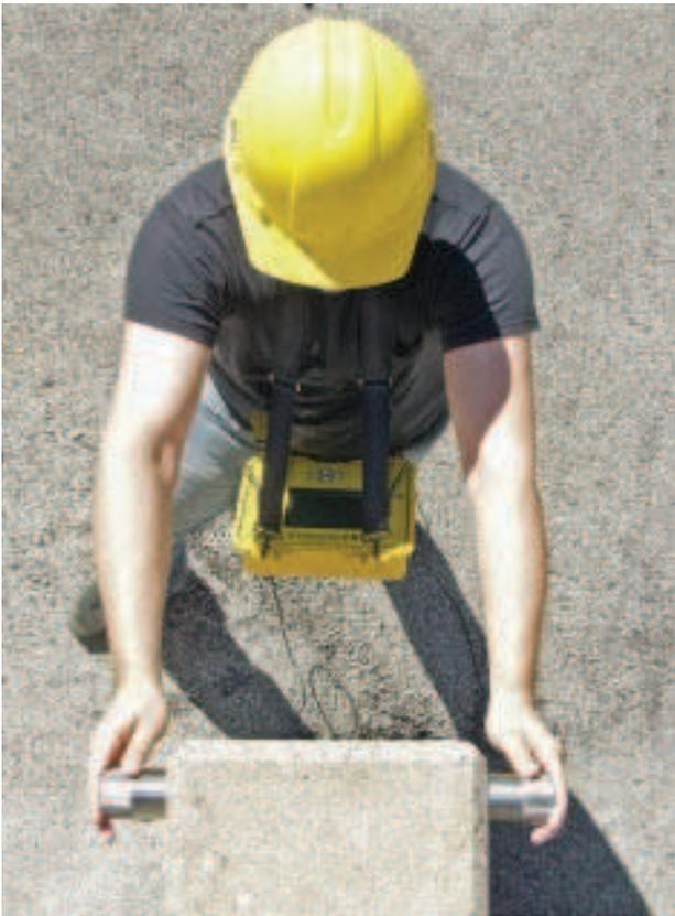
**V-meter Mk III siendo usado en configuración directa**
