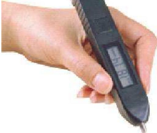
El medidor de vibraciones **TIME 7126** de Time Group Inc. es un instrumento de bajo costo extremadamente liviano y portátil, diseñado específicamente para realizar pruebas rápidas de chequeo de vibraciones causadas por desbalanceo, desalineamiento, etc.
