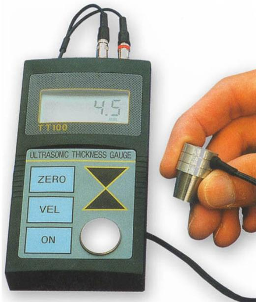
El **TT100** es un medidor de espesores ultrasónico de pared controlado por un microprocesador, específicamente diseñado para medir el espesor de materiales metálicos y no metálicos tales como Acero, Aluminio, Plásticos, Cerámicos y otros materiales buenos conductores del ultrasonido, que además tengan sus superficies superior e inferior paralelas.
