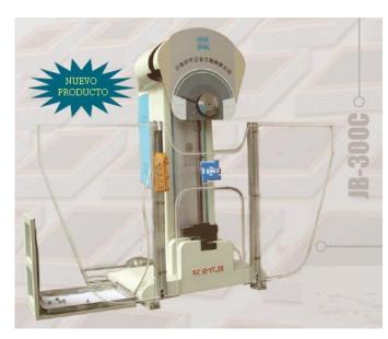
Se utilizan principalmente para determinar la capacidad para absorber impactos de materiales de alta tenacidad, especialmente fierro y acero y sus aleaciones, bajo una carga dinámica.
