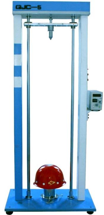
Para las pruebas de resistencia a la penetración de los cascos, el modelo de la cabeza está localizado firmemente a la base de la máquina, formando un circuito cerrado entre el modelo de cabeza, el martillo de penetración y el indicador eléctrico. Para la prueba de penetración se utiliza el martillo de 3kg de peso, dejándolo caer desde una altura de 1 metro. El resultado de la prueba se visualiza en el indicador digital, determinando así la resistencia a la penetración de los cascos.
