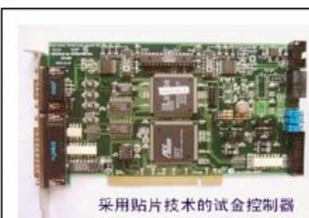
Tarjeta de control PCI, compatible con todos los PC y tarjetas madre. Medición y circuito de control totalmente digital. Provisto con canales de medición diferentes para carga, desplazamiento y deformación. Lazo de control cerrado mediante configuración simple del software.
