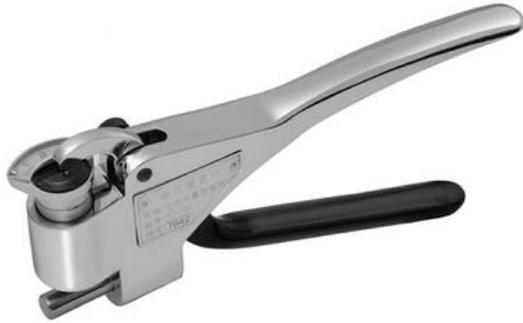
1. El durómetro Webster es un instrumento portátil que permite medir rápidamente la dureza de aleaciones de aluminio y otros metales blandos *in situ*. Cumple con la norma ASTM B647.
