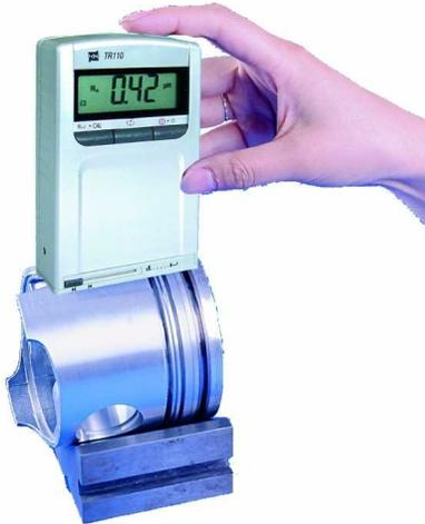
El **TIME3110** es un medidor de rugosidad de bolsillo, económico, para la medición de texturas superficiales conforme a patrones estandarizados. Puede ser usado en cualquier posición: horizontal, vertical o intermedias.
