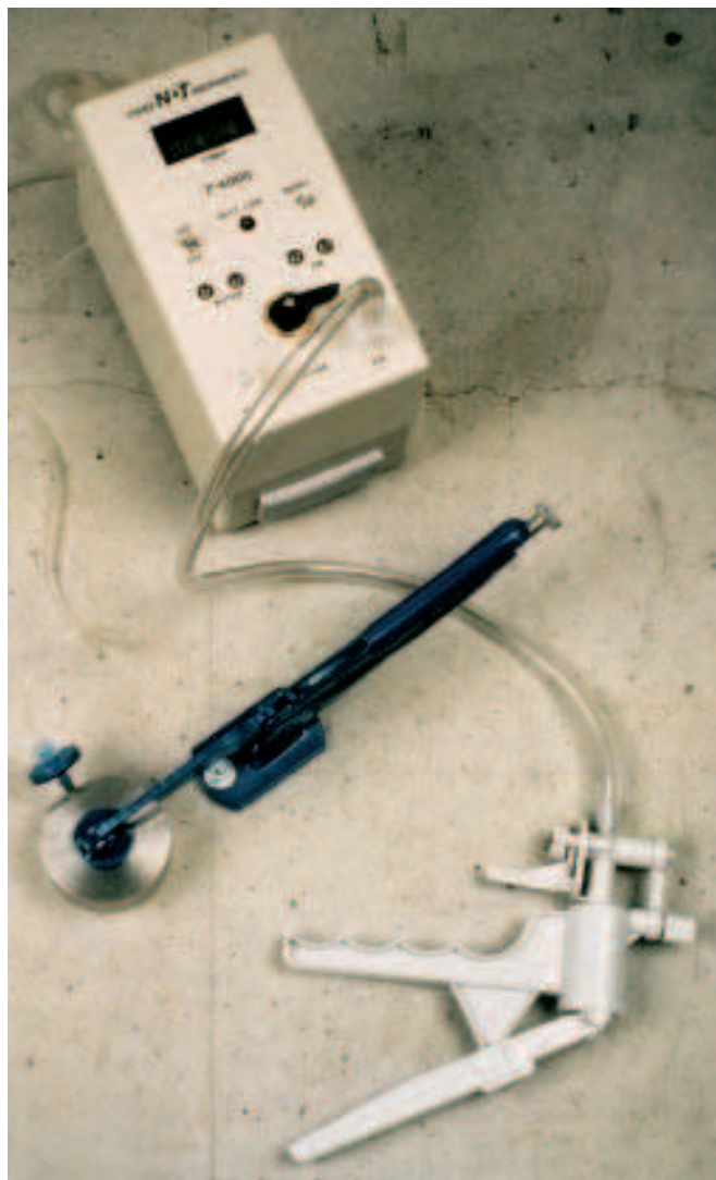
Prueba de Permeabilidad de Aire de Superficie
