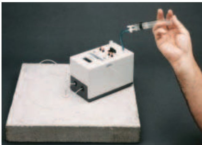
Prueba de Permeabilidad de Aire
